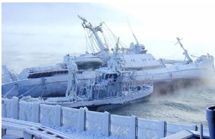
Рис. 3.16. Обледенение судов в порту, вызванное резким понижением температуры воздуха во время новороссийской бори
