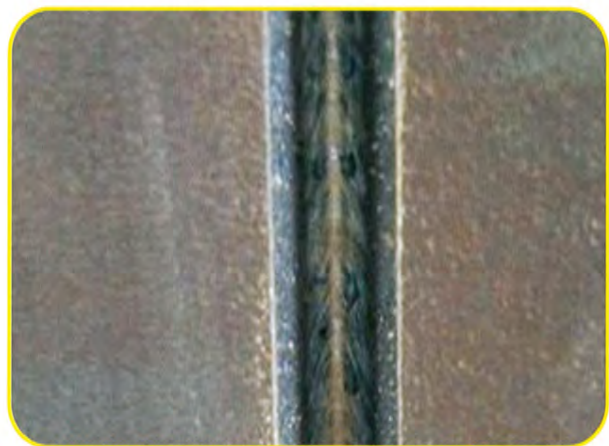
RMD + 金属粉芯焊丝根焊实际焊接效果
