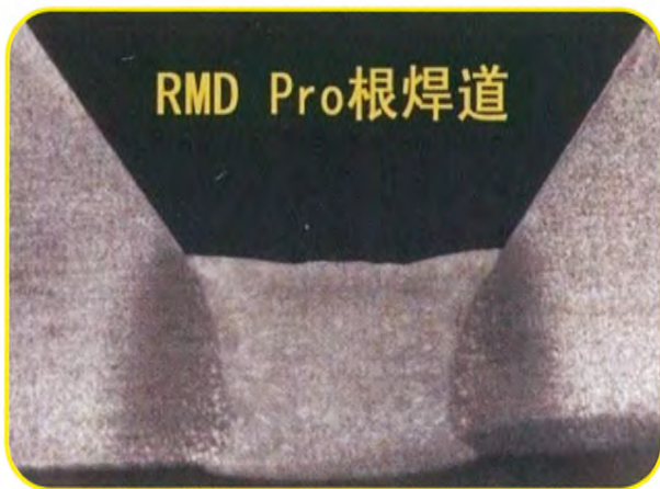
RMD + 金属粉芯焊丝根焊实际焊接效果
