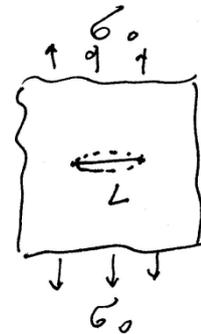
Systems erhöht, und zwar für den Riss im Beispiel um  $2\gamma\pi(L/2)^2$ . Dabei fällt aber die Normalspannung an den Rissufern von  $\sigma_0$  auf Null ab. Damit ist eine Verkleinerung der elastischen Energie verbunden. Wenn wir annehmen, dass die elastische Energiedichte  $w = \frac{\sigma_0^2}{2E}$  nun in einem Volumen (Kugel) von der Größenordnung  $L^3$  fehlt, so ist die gesamte
