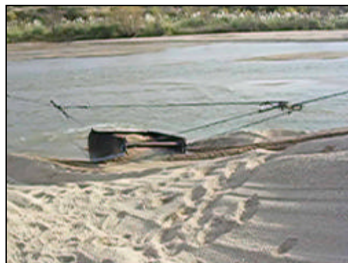
Figura7.- Extracción con Balde Volcador.
