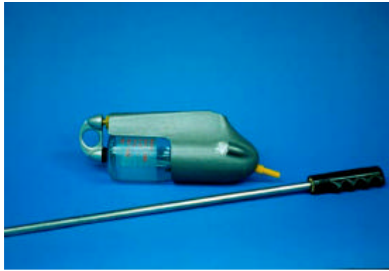
Figura5.- Muestreador US DH-48 para sedimentos en suspensión
