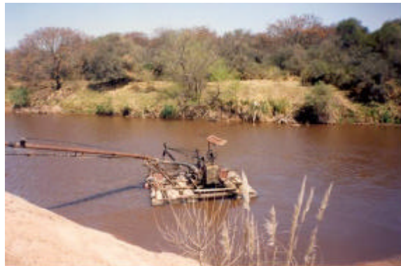
Figura9.- Balsa con bomba aspirante trabajando en el cauce del Río Segundo, tramo Plujunta
