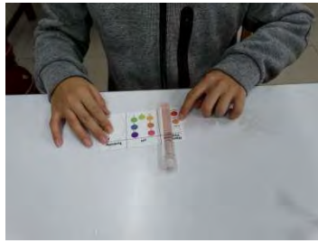
圖 4-4-14 檢測過濾後的污泥水溶氧量
