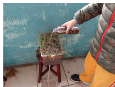
圖 4-4-9 將污泥水倒入簡易雨水滲透模型
