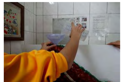
圖 5-2-9 加水至簡易湧泉水原理模型水管內測試
