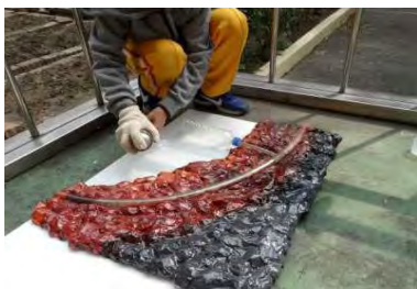
圖 5-2-7 模型表面噴上透明漆防水
