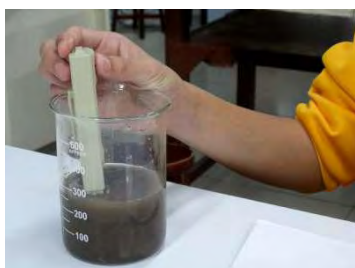
圖 4-4-8 檢測過濾前污泥水水中溶質量
