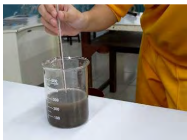
圖 4-4-7 檢測過濾前污泥水溫度
