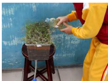
圖 4-4-10 將雷裡池水倒入簡易雨水滲透模型
