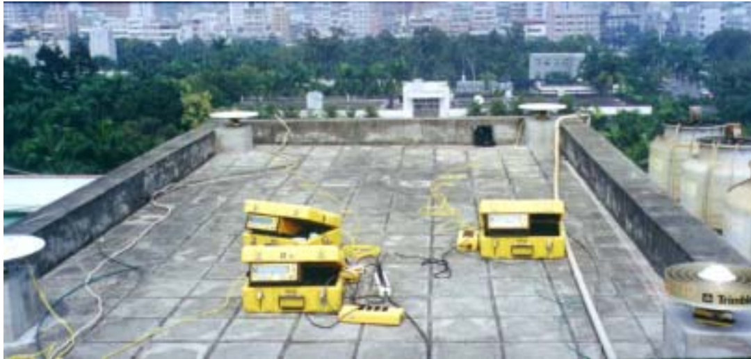
圖 3-7 相位中心率定外業施測情形一
