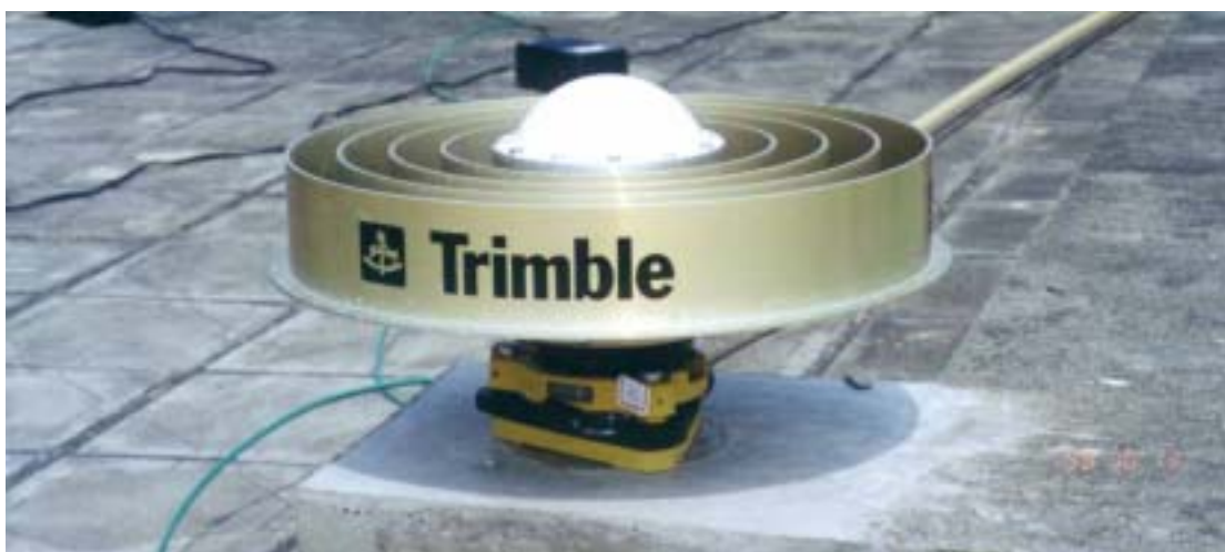
圖 3-9 相位中心率定外業施測情形三
