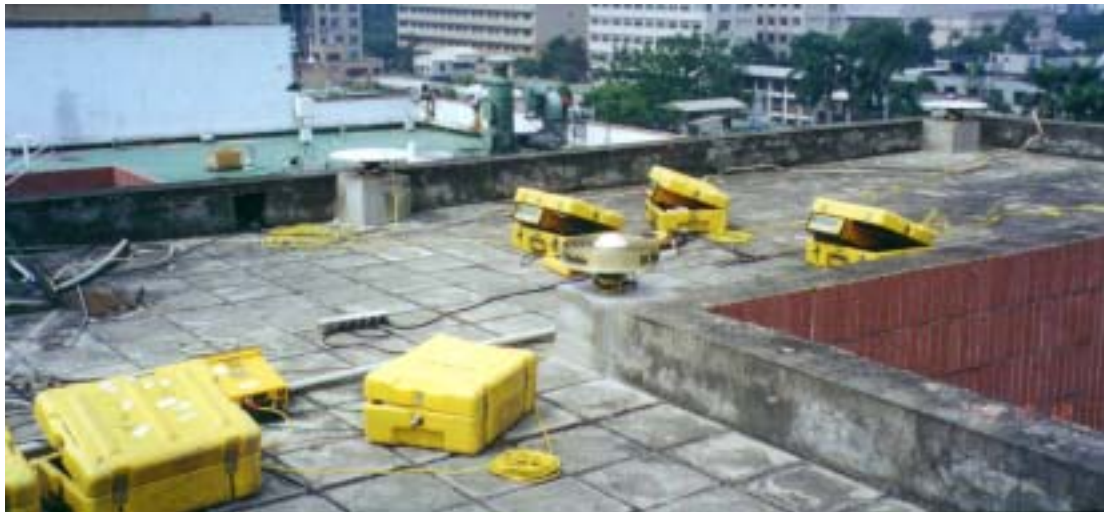
圖 3-8 相位中心率定外業施測情形二
