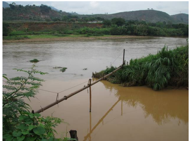
Figura 14 - Tubo de adução de areia na confluência entre o córrego Melo Viana e o rio Piracicaba em Coronel Fabriciano. Foto: Lume, 2008.
