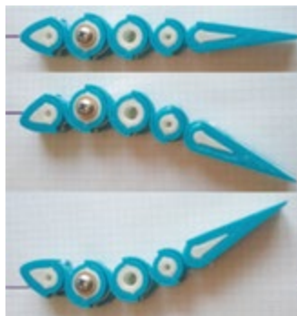
Рис. 5. Макет профиля адаптивного крыла в различных положениях
