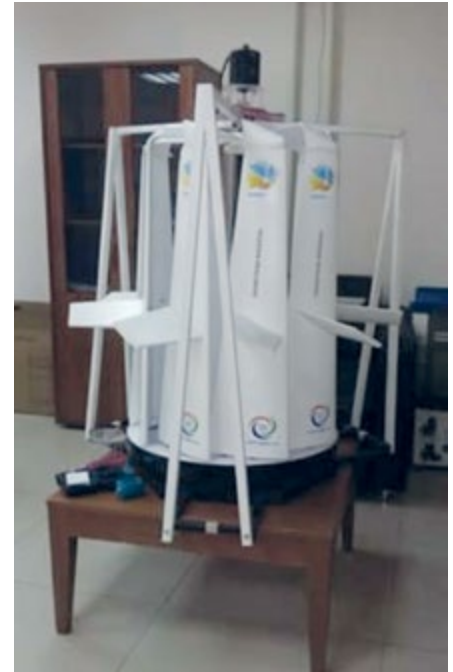
Рис. 2. Действующая модель турбины с девятью антикрыльями
