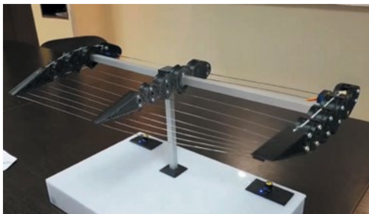
Рис. 7. Действующий макет конструкции каркаса адаптивного крыла
