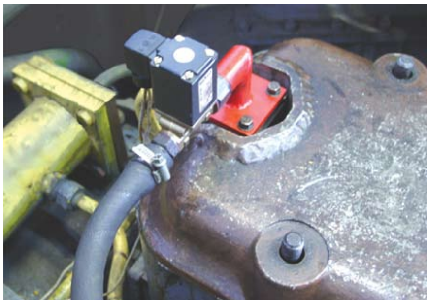
Рис. 4. Электромагнитный клапан подачи газа на макетном образце газотепловоза ТЭМ2Г
