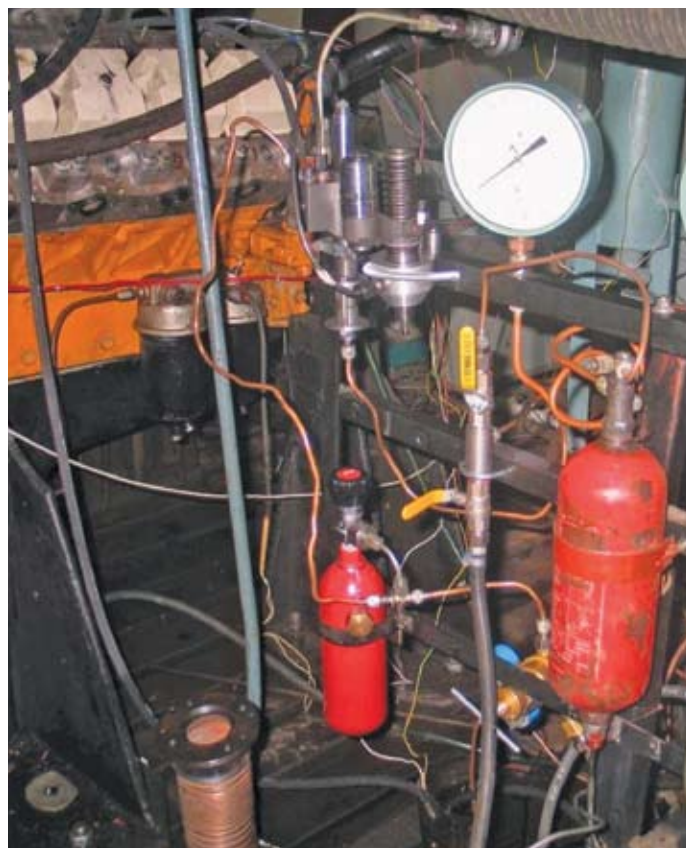
Рис. 11. Безмоторная установка для доводки ГГФ
