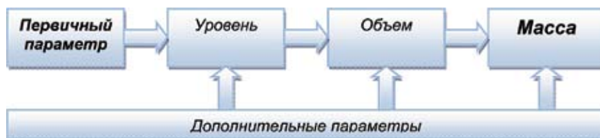
Рис. 1. Традиционный метод измерения массы СУГ в резервуаре
