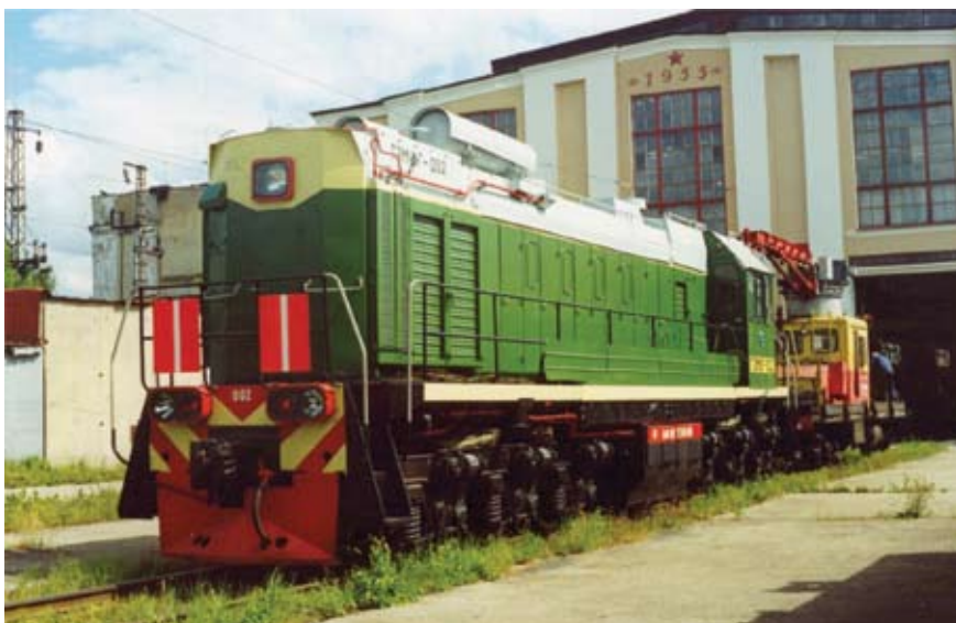
Рис. 1. Маневровый газотепловоз ТЭМ18Г-002 на Экспериментальном кольце ВНИИЖТ (г. Щербинка)
