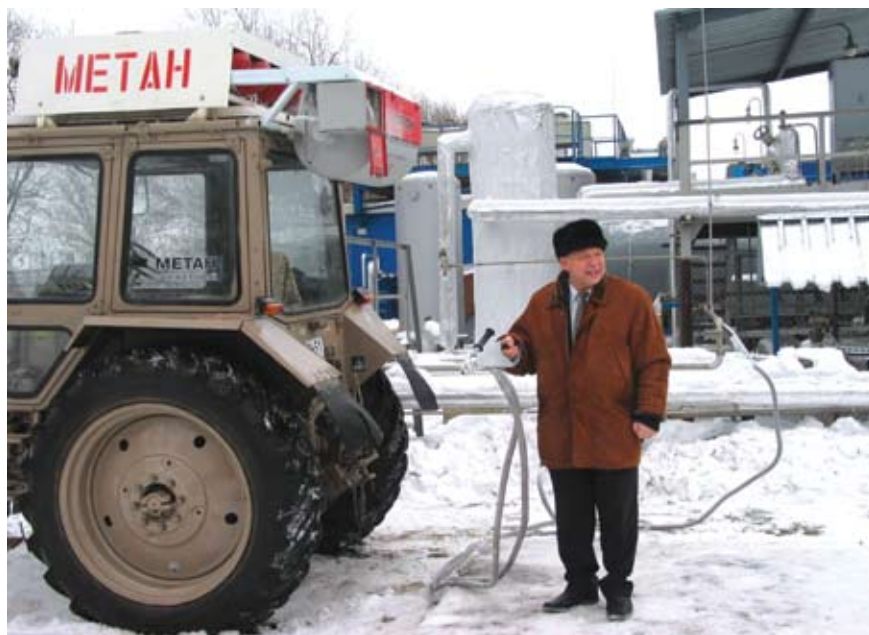
Фото 1. Сельскохозяйственный трактор, использующий в качестве бортового моторного топлива СПГ, оснащённый криогенным баком и топливной системой. Замена КПГ на СПГ на сельскохозяйственных механизмах позволяет снизить давление колёс на грунт и упростить процесс его доставки.
