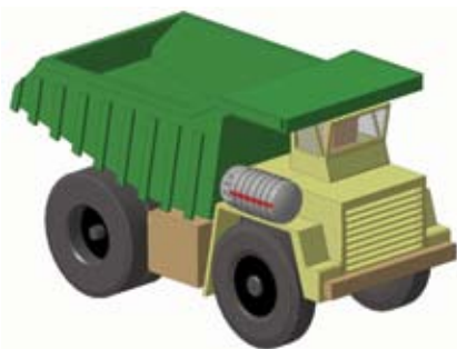
Рис. 1. Расположение криогенного топливного бака объёмом 560 л на карьерном самосвале БелАЗ-75485. Для использования КПГ и создания эквивалентного бортового запаса природного газа необходимо установить около 30 баллонов ёмкостью 50 л. Монтажный объём баллонов около 3,0 м 3 , а масса более 2,0 т.
