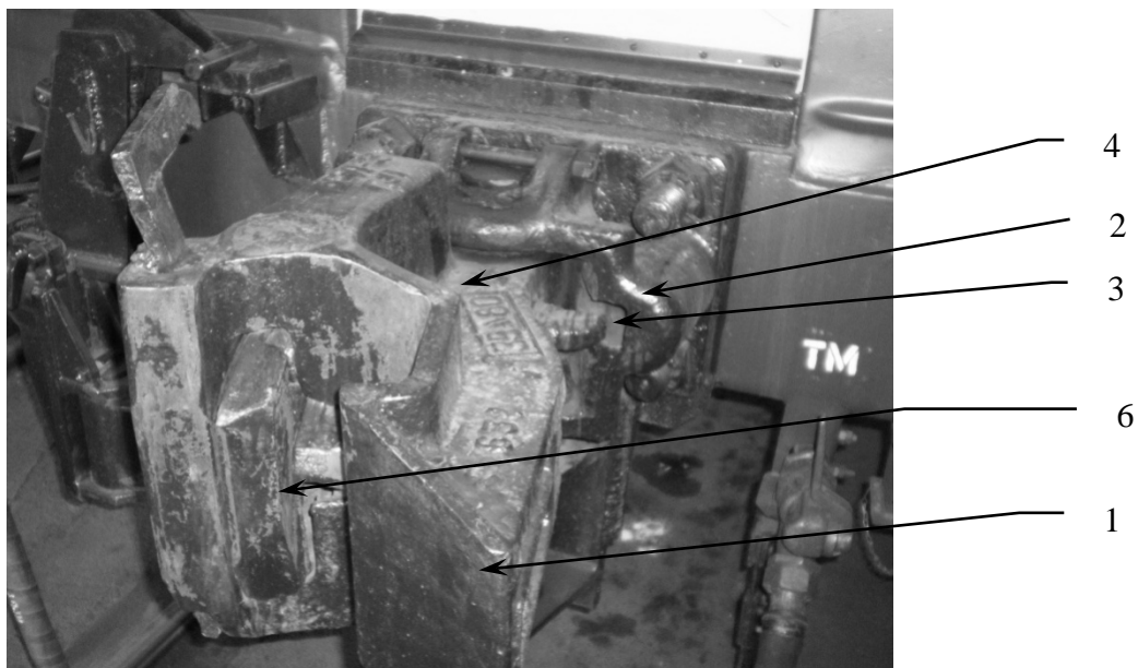
Рис.3 Локомотивная железнодорожная автосцепка СА-3
