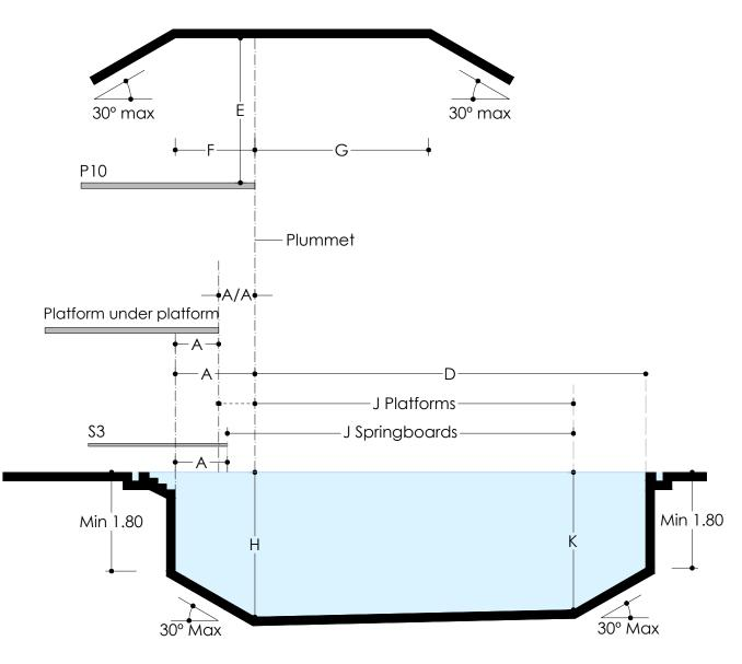
CROSS SECTION LONGITUDINAL SECTION
