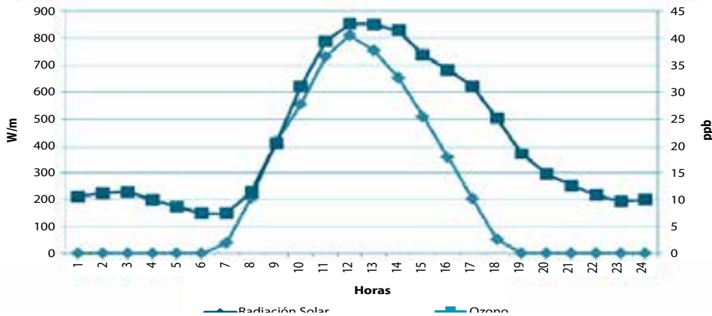
Gráfica 123 Correlación horaria entre la radiación solar y las concentraciones de ozono en Bogotá 2010
