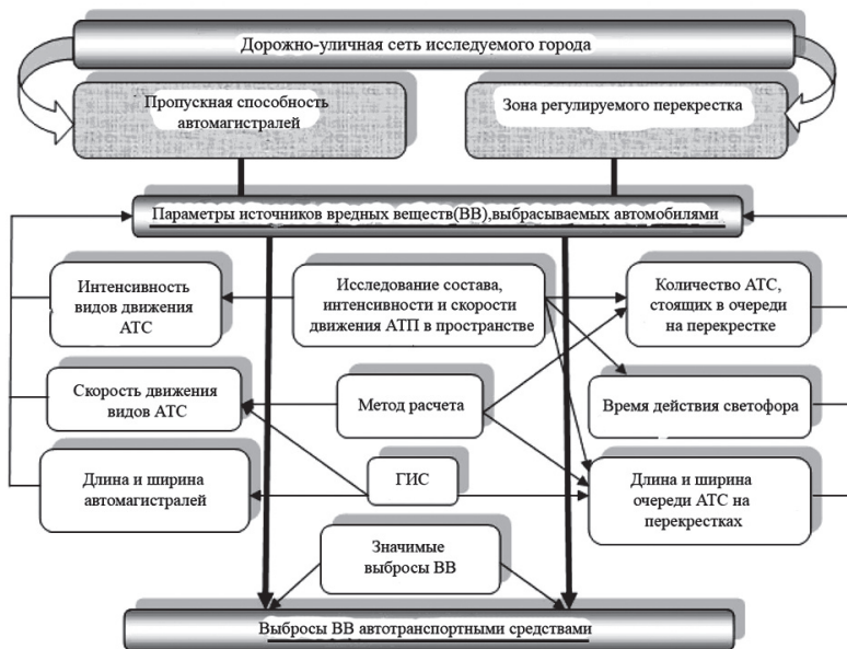
Рис. 4. Блок-схема расчета максимальных загрязняющих веществ от автотранспорта с использованием ГИС
