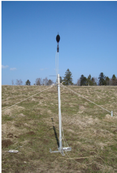
Abb. 46: Links: Installierte Schallmessung. Rechts: Zeitlicher Verlauf des Schallpegels.
