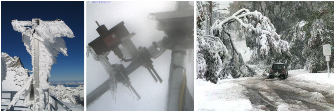
Abb. 16: Verschiedene Arten der Vereisung. Links: Raureif, Mitte: Klareis, Rechts: Nassschnee
