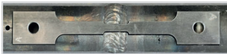
Bild 1. Zugprobe entnommen aus einer Schweißverbindung.
