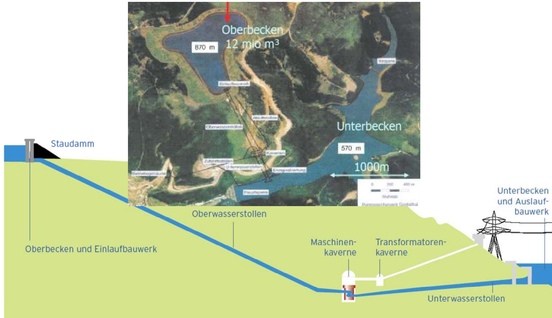
Schematische Darstellung des Pumpspeicher-Kraftwerkes Goldisthal
