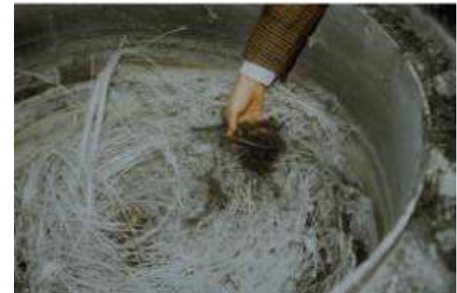
Geborstenes Schwungrad (Kohlefaser verstärkter Kunststoff)
