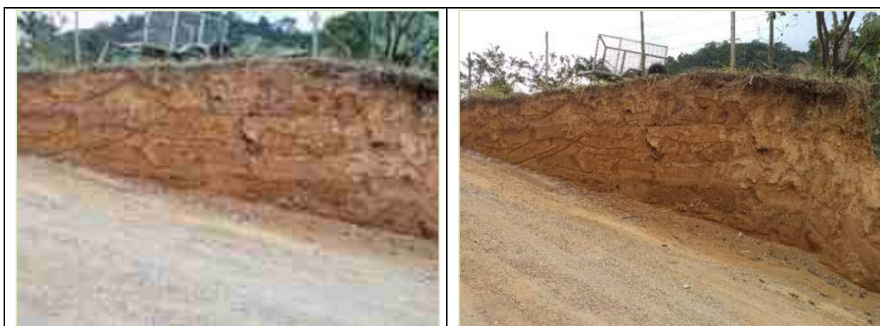
FIGURA 3.49: PERFIL DE LATOSSOLO AMARELO. COORDENADAS UTM 23S 749.065 E 7.835.861. Fonte: Detzel et al., 2020.
