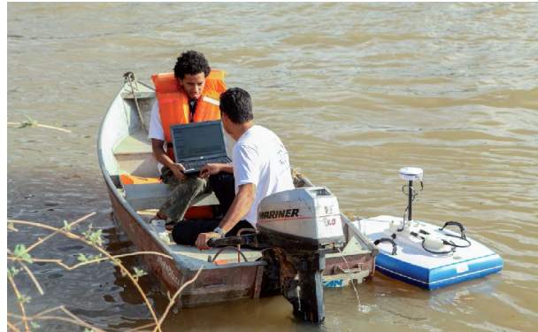
Medição de vazão com o uso do ADCP
