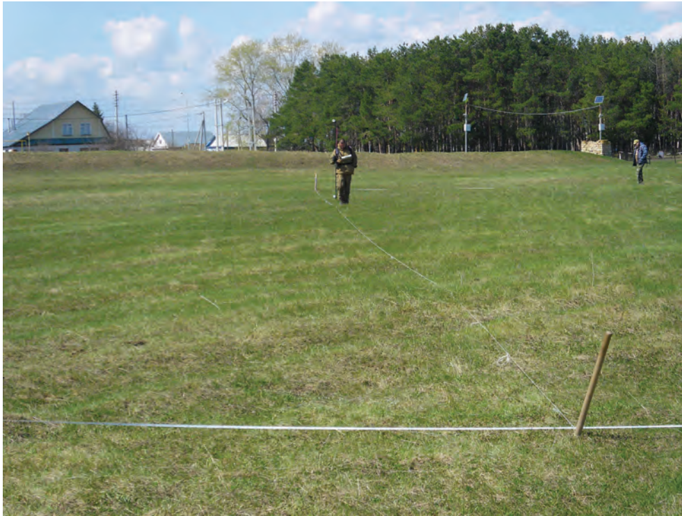
Рис. 1. Рабочий момент магнитометрических исследований градиентометром POS-2. Fig. 1. A routine procedure of magnetometric survey with the POS-2 gradiometer
