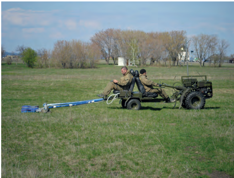
Рис. 3. Рабочий момент георадарных исследований многоантенным георадарным комплексом МАРК 300-8.
