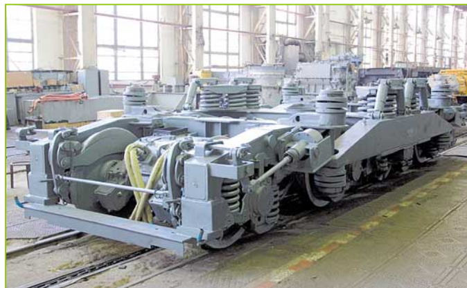
Рис. 2. Четырехосная тележка состоит из двухосных, соединенных между собой промежуточной рамой. Рессорное подвешивание — двухступенчатое
