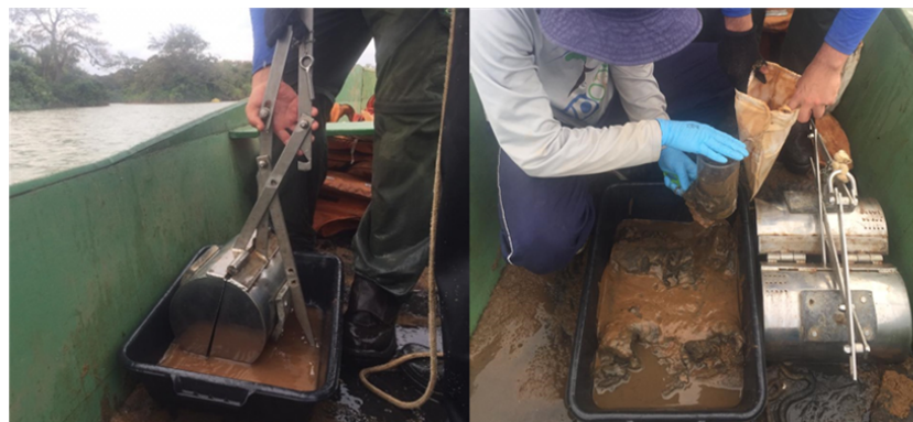
Figura 6. Coleta do sedimento do fundo do rio com pegador do tipo van-veen. Os sedimentos foram peneirados e as amostras acondicionadas e preservadas para posterior triagem laboratorial e identificação taxonômica dos organismos bentônicos.
