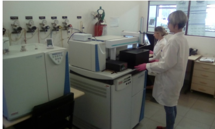
Figura 3. Análise de deutério e oxigênio-18 por IRMS em laboratório do CD'TN.
