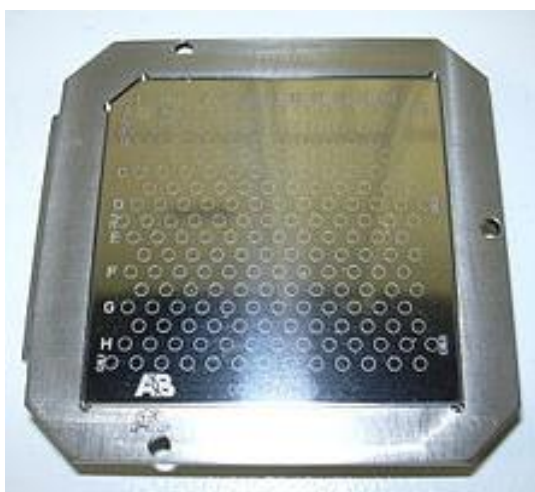
Figura 30. Placa própria para espectrômetros do tipo MALDI onde foram ‘espotadas’ as amostras peptídicas extraídas dos spots do gel bidimensional 1A da peçonha de L. m. rhombeata . Fonte: < http://en.wikipedia.org/wiki/Matrix-assisted_laser_desorption/ionization >. Acesso em 17 de dezembro de 2012.
