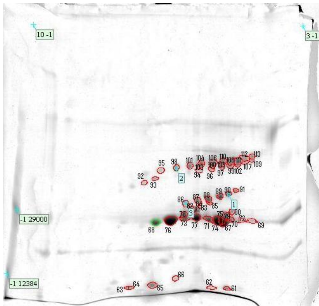
Figura 28. Detecção e seleção dos spots proteicos da peçonha da serpente L. m. rhombeata por meio do software ImageMaster 2D Platinum . Replicata 2A contendo 53 spots (marcados de 61 a 113). A faixa de pH varia de 3 a 10. Foi visualizado o marcador de massa molar: 29kDa = anidrase carbônica e 12kDa = citocromo C. Os números 1, 2 e 3 (retângulos azuis) referem-se aos land markers .
