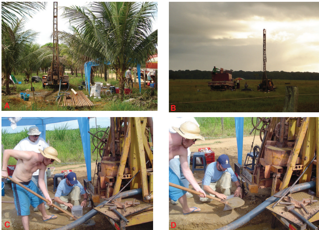
Figura 3: Equipamento de sondagem rotativa utilizado (A e B) e procedimento para coleta de amostras de calha (C e D).
