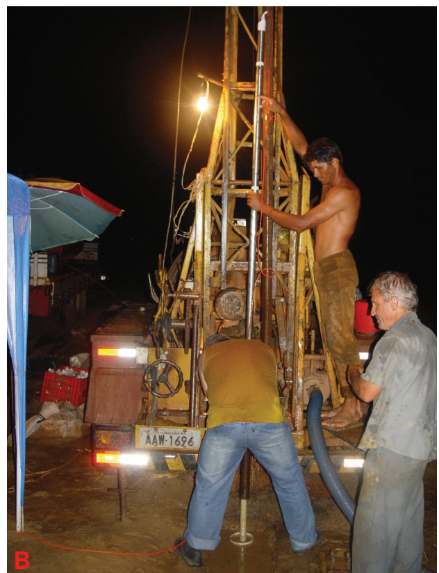
Figura 4: Perfilagem geofísica dos poços. Em A é mostrado o equipamento que armazena as informações, em B operação do equipamento perfilador.
