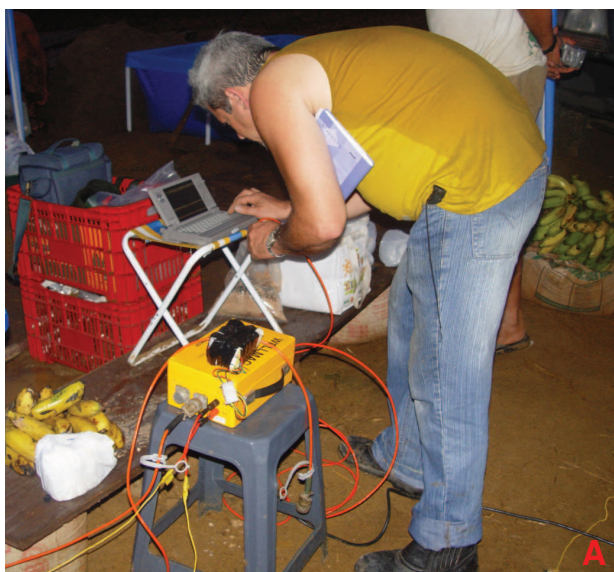
Figura 4: Perfilagem geofísica dos poços. Em A é mostrado o equipamento que armazena as informações, em B operação do equipamento perfilador.
