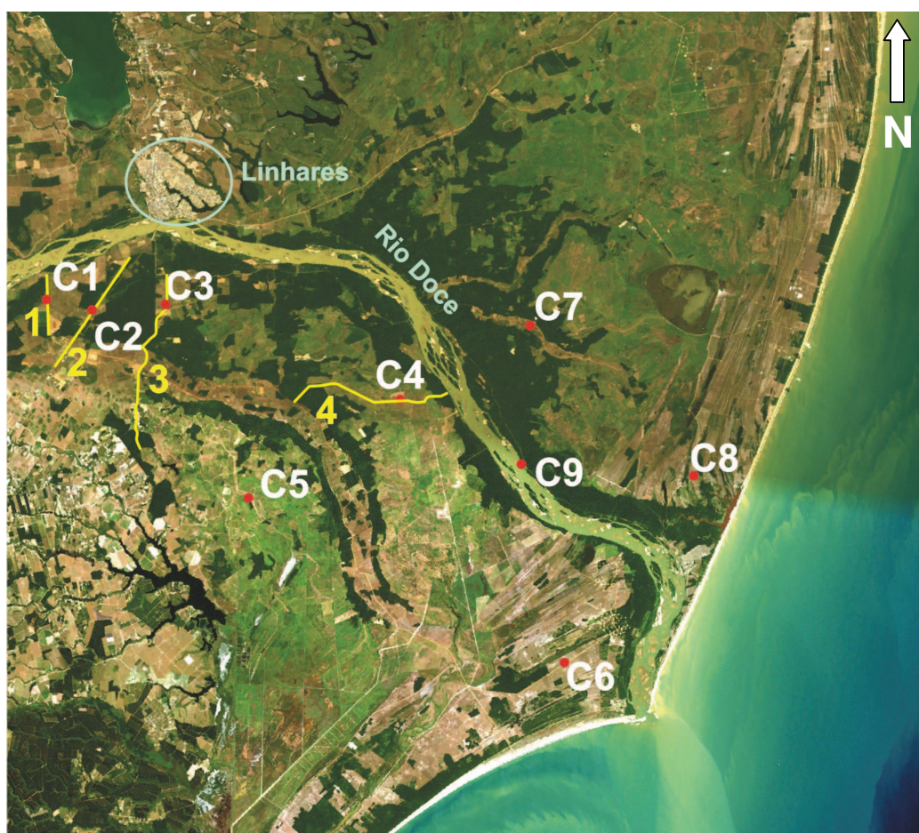
Figura 30: Imagem de satélite com a localização dos levantamentos geofísicos (levantamentos geofísicos em amarelo: 1 –Bebedouro, 2 – BR 101, 3 – Ilha e 4 – Maria Bonita), dos furos sondagem (C1 – C9) realizadas na Bacia do Baixo Rio Doce.
