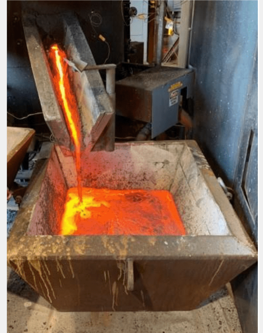
Matte pour post converting. End-product is NiCuCo matte.
