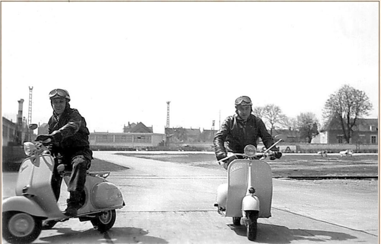
Profession : Essayeur ! L'anneau d'essai des scooters, plus grand qu'un stade de football. A l'époque nous étions 15 sous les ordres de Jean Véron afin de procéder aux réglages des freins, des suspensions, du ralenti et du passage des vitesses, avant une ultime finition sur la chaîne.
