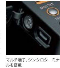
レーザーと接続したカメラのリモートリリースが可能 ※5
