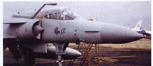
Foto 2: Detalle de la nueva sección delantera del fuselaje del KFIR CE, C-10 ó 2000 de la Fuerza Aérea ecuatoriana. Obsérvese el nuevo frontal de la cabina, totalmente de una pieza. (Foto: Roberto Bertazzo)
