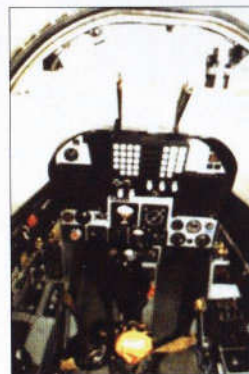
Foto 2: Detalle de la nueva sección delantera del fuselaje del KFIR CE, C-10 ó 2000 de la Fuerza Aérea ecuatoriana. Obsérvese el nuevo frontal de la cabina, totalmente de una pieza. (Foto: Roberto Bertazzo)
