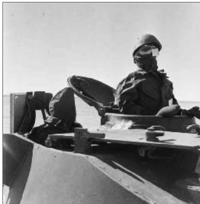
Figure 7 bis : Tests de matériels inertes (mannequins sur un blindé) lors des expérimentations aériennes au CSEM
