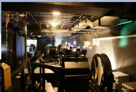
▲ 低分辨率光谱仪（16台）和CCD相机（32台） 16 low resolution spectrographs and 32 CCD cameras
