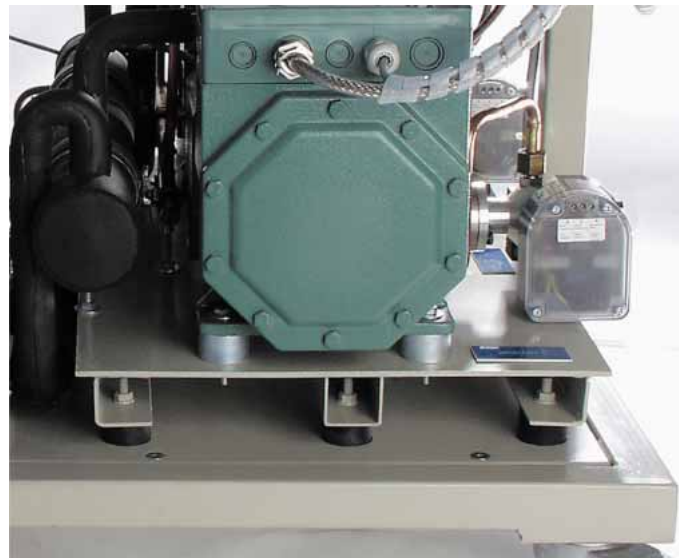
Bild 4: Schwingungsentkoppelung der Verdichterbaugruppe
