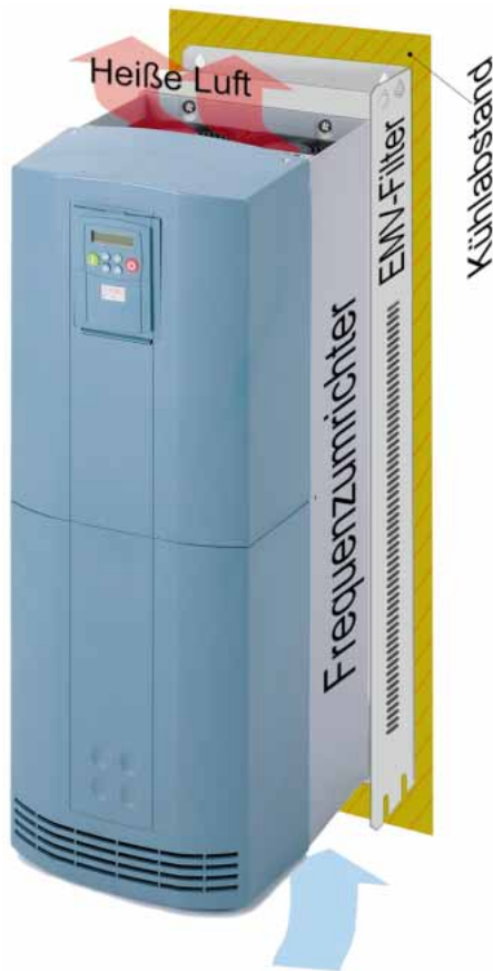
Bild 9: Abstände zur Gerätemontage
