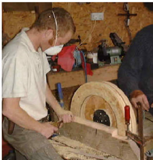
Rotation af en statorform ved hjælp af en elektrisk motor
