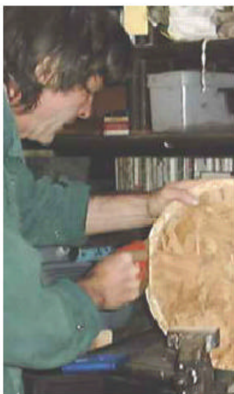
Udformning af de flade kanter på den indre form.
