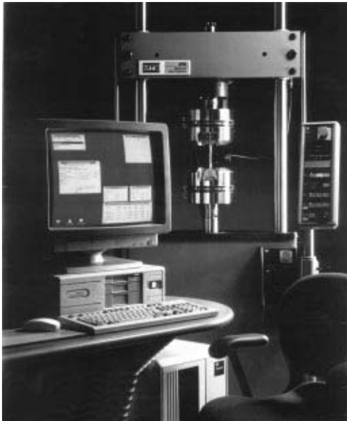
30. ábra. Napjaink digitális vezérlésű és adatfeldolgozású anyagvizsgáló rendszere
