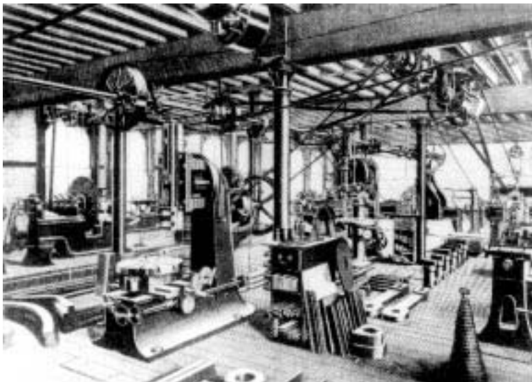
13. ábra A próbatestek kimunkálására alkalmas berendezések Kirkaldy laboratóriumában
