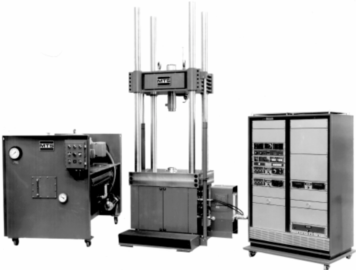
23. ábra. Az első generációs zárt vezérlésű MTS rendszer
