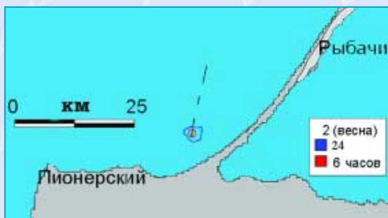
Зоны риска поражения акватории в пределах 6 и 24 часа при аварийном сбросе нефти на нефтепроводе от ЛСП на береговой терминал с учетом ликвидации аварийных разливов нефти
