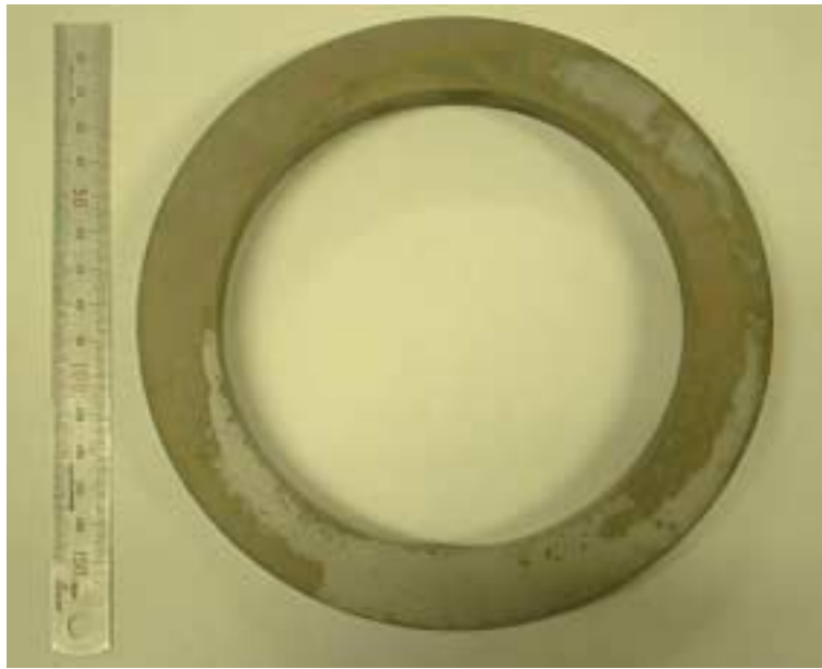
図 2.1.2-1 180mm 磁気回路用リング一体磁石の焼結体写真
