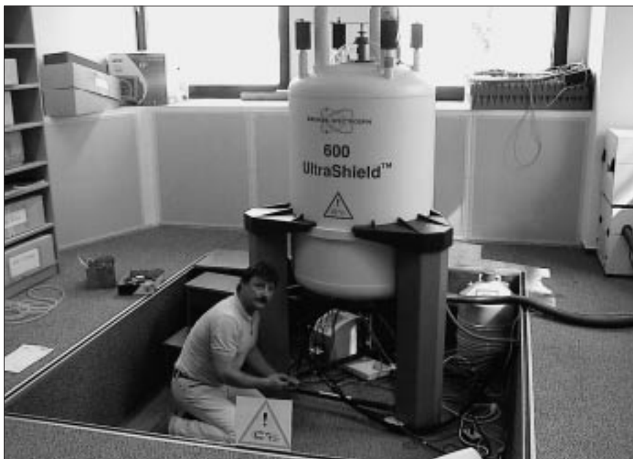
Dr. Matthias Findeisen bei Justierungsarbeiten am 600-MHz-Spektrometer.
