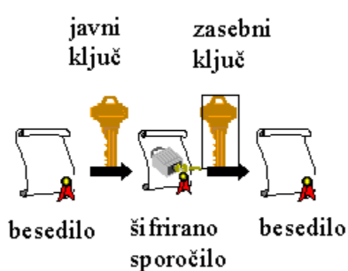
Slika 8.1: Princip asimetričnih algoritmov
