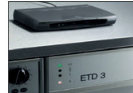
RDG-E mit ISDN-Router zum Einsatz mit Fernwartung.
