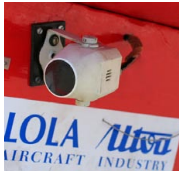
Bočna kamera na levoj strani trupa letelice FOTO ARHIVA AIRSERBIA
