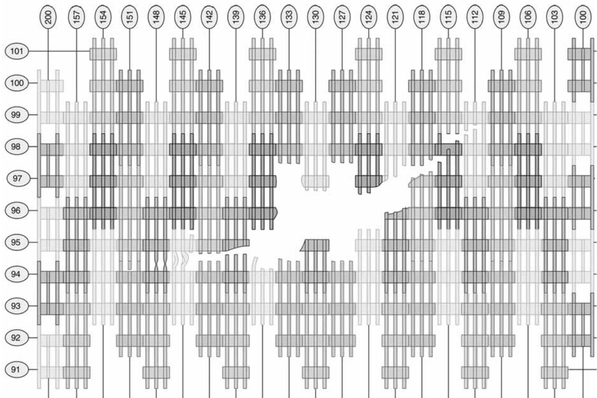
Bild 21: Einschlag-Schaden an den Außenstützen der Nordfassade von WTC 1 [1]
