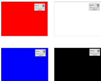
Figur 6.9 Kalibrerings/profileringsprogramvaren sender et sett kjente verdier til monitoren for kalibrering og deretter for lagring av verdiene i en profil.
