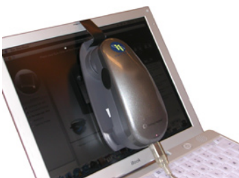
Figur 6.3 EyeOne spektrofotometer: Her for bruk til kalibrering og profilering av monitor.
