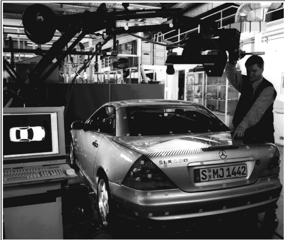
Abbildung 2.13 : Komplette Vermessung eines Mercedes SLK mit dem freifliegenden Sensor Ganymed 97, (c) Daimler-Benz AG, FT4/TM, Ulm, 1997
