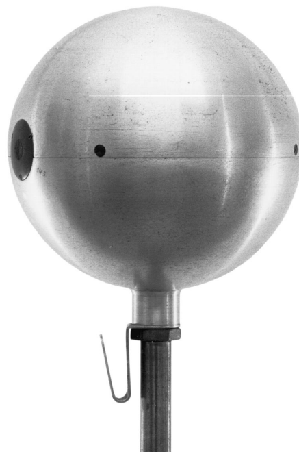
1.b 1955, SCHOEPS-Laborprodukt Aluminium-Hohlkugel mit 20cm Durchmesser mit eingebauten Druckempfängern im Winkel 180°
