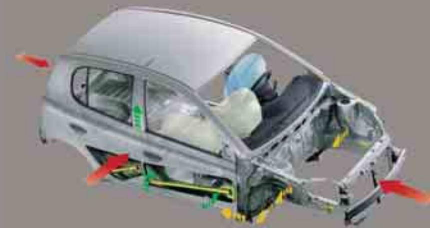
4 airbag sono di serie, ma tutta la scocca offre la massima resistenza agli urti grazie anche alle barre antintrusione laterali e all'inserimento di materiali ad assorbimento d'urto all'interno della vettura.
