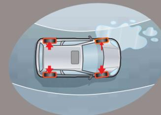
L'ABS a 4 sensori con ripartitore elettronico della forza frenante (EBD) è di serie come le cinture di sicurezza posteriori tutte a 3 punti di ancoraggio.
