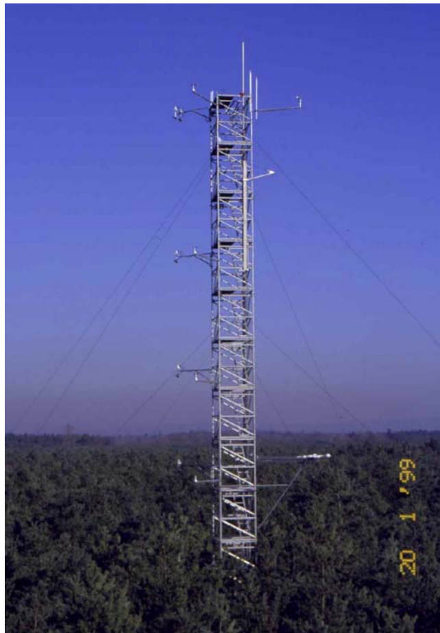
Abb. 10: Großer Messturm auf der Forstmeteorologischen Messstelle Hartheim des Meteorologischen Institutes der Universität Freiburg (Januar 1999)
