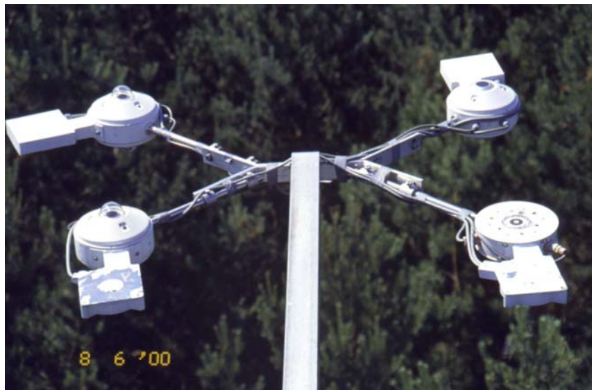
Abb. 11: Strahlungsmesswertgeber an der Forstmeteorologischen Messstelle Hartheim (links: 4 Pyranometer zur Messung von Globalstrahlung und kurzwelliger Reflexstrahlung; rechts vorne: Strahlungsbilanzmesser nach Schulze; rechts hinten: Pyrgeometer von Kipp & Zonen)
