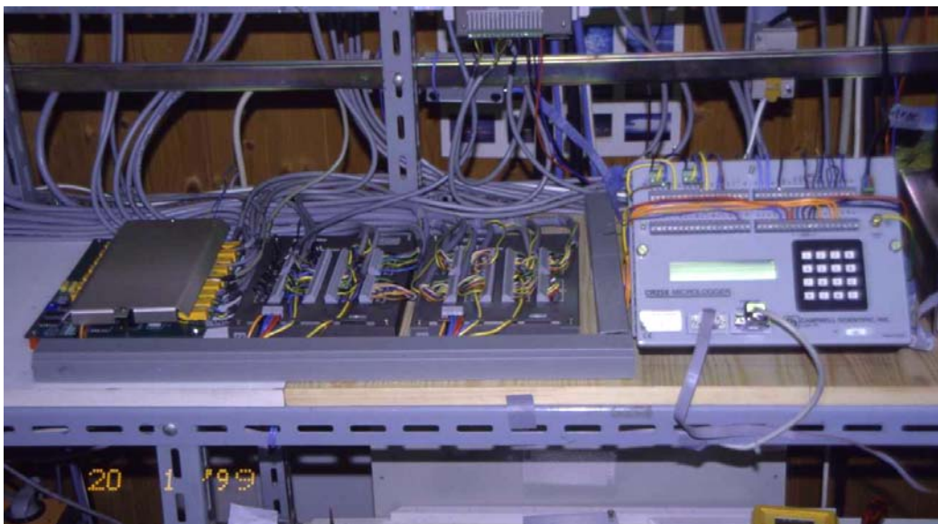
Abb. 15: Datalogger vom Typ CR23X der Firma Campbell zur Datenerfassung auf der Forstmeteorologischen Messstelle Hartheim
