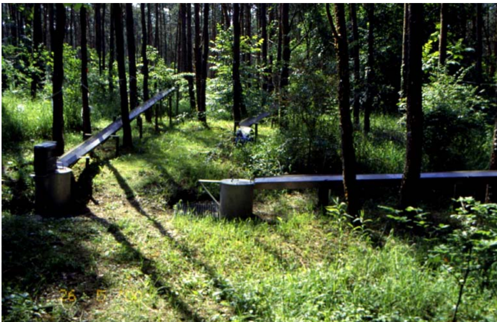
Abb. 13: Regenrinnen zur Messung des Kronendurchlasses im Waldkiefernbestand an der Forstmeteorologischen Messstelle Hartheim (Mai 2000)
