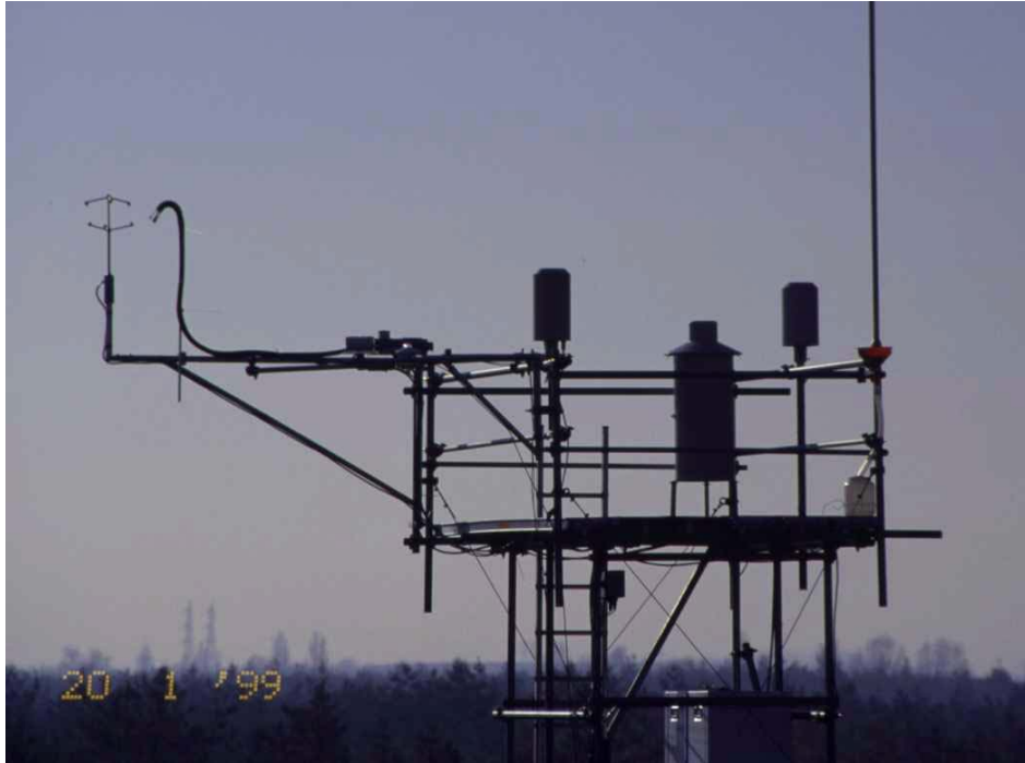
Abb. 12: Drei Niederschlagsmessgeräte (in der Mitte) zur Messung des Freilandniederschla- ges über dem Kiefernwald an der Forstmeteorologischen Messstelle Hartheim; links ein Ultraschallanemometer (Januar 1999)
