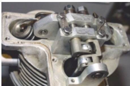
Excam. Husqvarnas egna konstruktion av tvångstyrda ventiler. Den möjliggjorde att motorerna kunde varvas mer än vanliga motorer.
