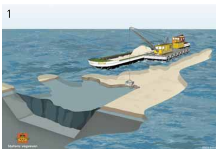
1 Topplaget av forurensede sedimenter fjernes. Deretter graves det ei grøft gjennom rein leire for å gi rom til tunnelen. (Illustrasjon: Arild Solerød)
