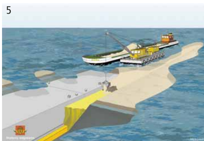
5 Masser legges tilbake over tunnelen. (Illustrasjon: Arild Solerød)
