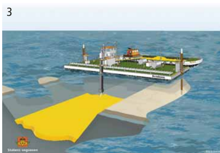
3 Grus pumpes ut på bunnen av grøfta med stor nøyaktighet. Dette blir tunnelens fundament. (Illustrasjon: Arild Solerød)
