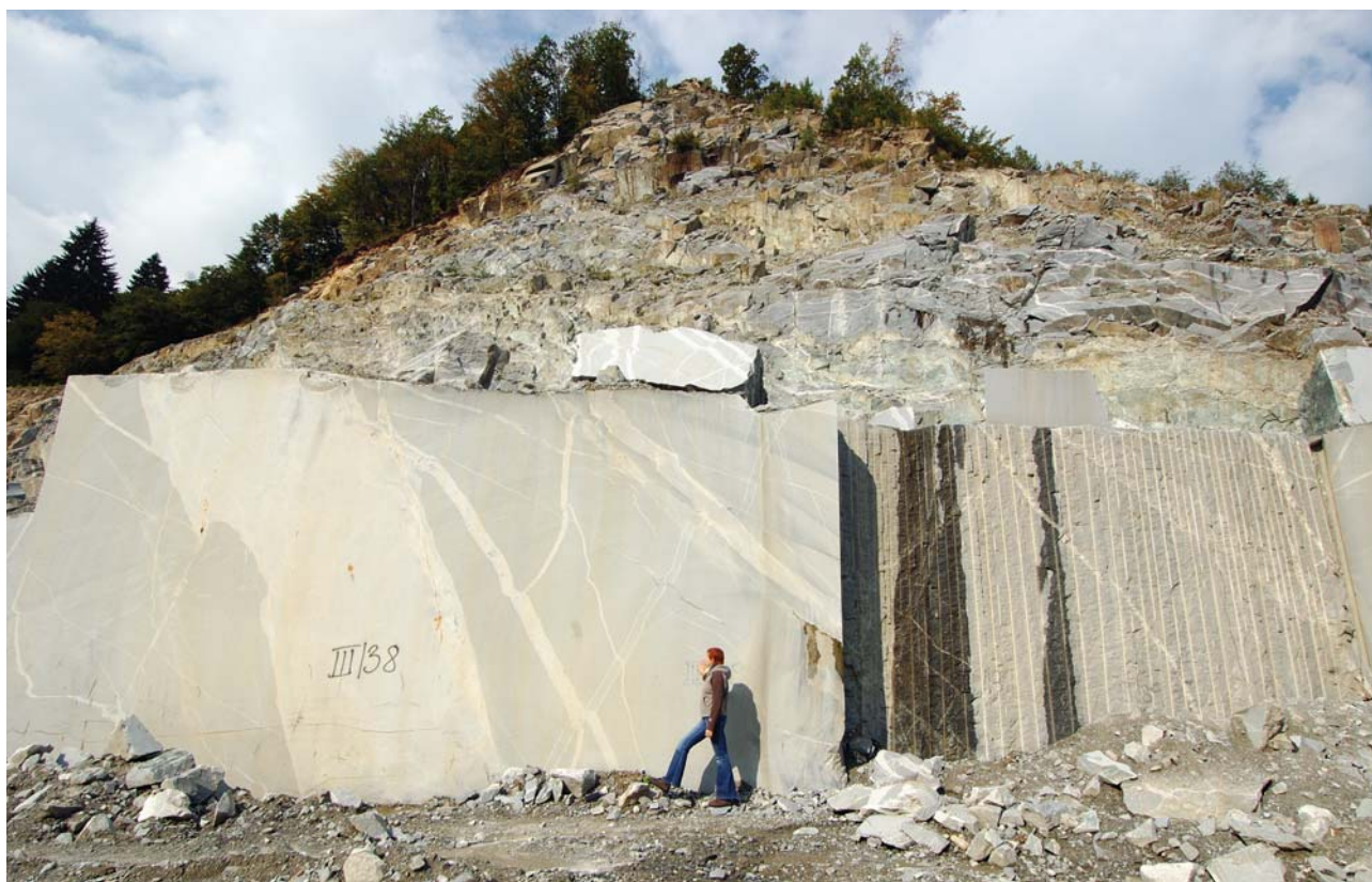
Slika 6: S pomočjo moderne tehnologije lahko danes v kamnolomu naenkrat odrežejo ogromne kose kamnine, ki jo odlikuje nerazpokanost, kar je eden poglavitnih atributov cezlaskega kamna (foto: Domen Grögl).
