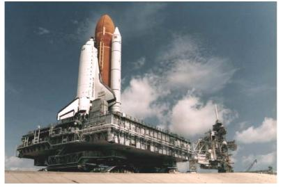
Mitte: Für die Reparatur musste das ganze System (Trägerrakete, Treibstofftanks und die Raumfähre Space Shuttle) wieder aus der Startrampe ausgebaut und mit der überdimensionalen selbstfahrenden Lafette wieder in die Montagehalle zurück gebracht werden.
