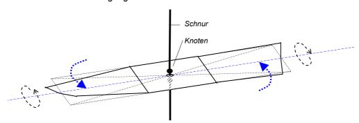
Ausreichend lange Schnur-Überlängen, oberhalb und unterhalb der "Blechstreifenzone" gewährleisten, dass auch schwer zugängliche Stellen "überspannt" werden können. Die Gesamtlänge des Windspiels und Anzahl der Bleche sind dem zu schützenden Fassadenbereich anzupassen.
