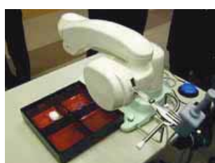
「福祉ネットワーク」で紹介 した食事介護ロボット「マ イスプーン」の展示とデモ ンストレーション。
