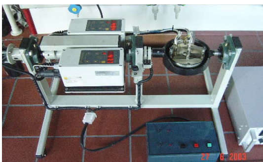
Abb. 3: Thermoadhäsions-Anhaftapparatur, Typ: TaA1, Bauart: Hochschule Zittau/Görlitz, 2003
